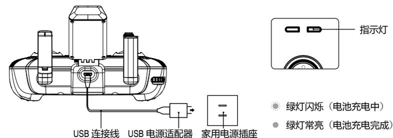
**警告：**使用遥控器时，须断开充电器连接线。
