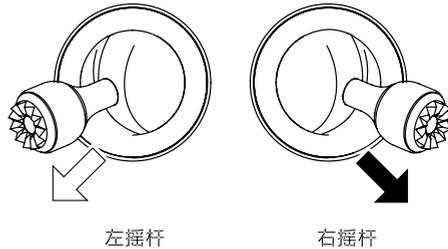
向上推动油门摇杆，让飞行器较快地离开地面，然后操控油门摇杆让飞行器缓慢上升。
