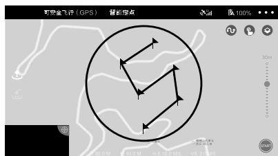
线飞行），并阅读注意事项。在当前地图中根据自身需求点击屏幕，设定途经点，并在屏幕右侧设定飞行高度（默认高度为30m）。设定完毕点击
