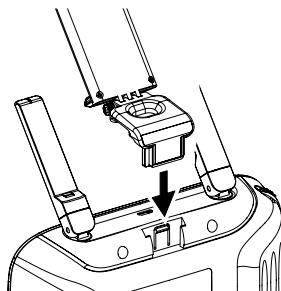
b. 将手机支架插入遥控器背面的卡槽中
