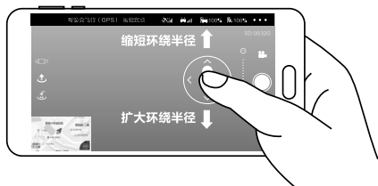
控制右虚拟摇杆扩大或缩短环绕半径 (上图以左手油门模式为例)
